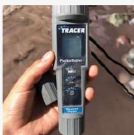
Además contamos con dos instrumentos más, un **Turbidímetro** (a la izquierda) que permiten medir la Turbiedad y un **Medidor de Oxígeno disuelto** (a la derecha). Ya que contamos con sólo un instrumento de cada tipo, se mide en un sólo punto cada mes.
