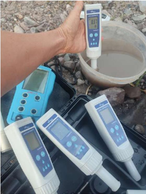
Los monitores que guardan los kits tienen soluciones de pH y conductividad para calibrar el instrumento antes de cada mes de medición. Además, cada 3 meses nos reunimos para calibrar y comparar los 4 instrumentos multiparámetros. Las variaciones entre instrumentos es despreciable (Tabla 5).
